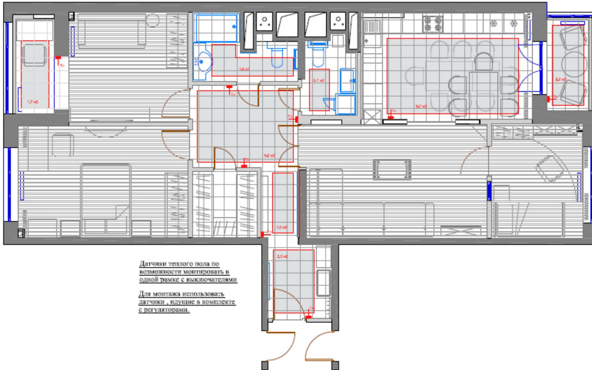
Датчики теплого пола по возможности монтировать в одной рамке с выключателями
